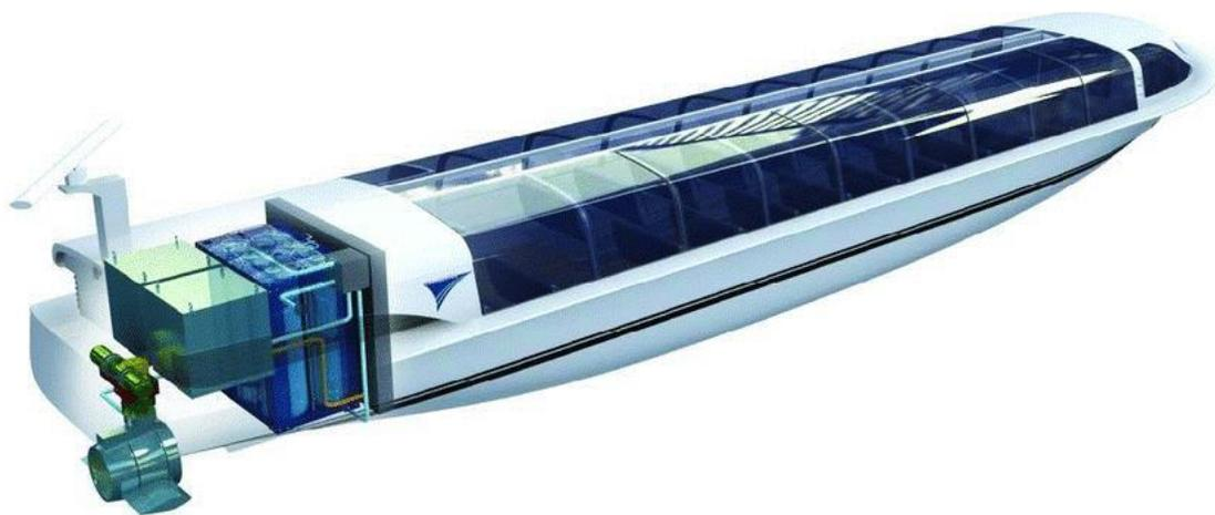
Figura 119. Imagen de una embarcación propulsada por hidrógeno.
