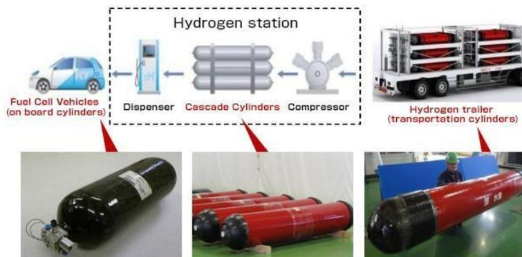
Figura 44. Sistemas de almacenamiento presurizado en estaciones de servicio.
