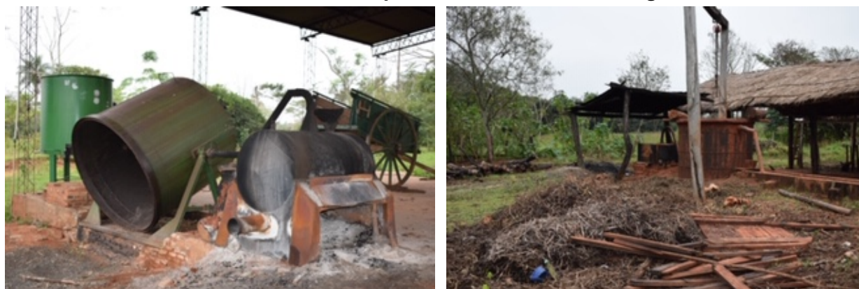
Foto 13 – Instalaciones Rudimentarias para la Destilación de Petitgrain
