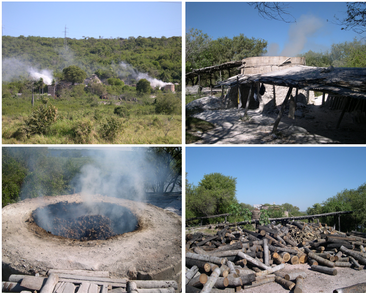
Foto 07 – Fotos que Ilustran la Producción de Cal Viva en San Lázaro
