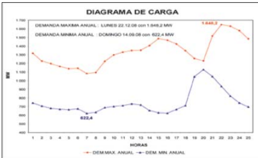
GRÁFICO 5.2.1.2. ESTRUCTURA DE CURVAS DE DEMANDAS MÁXIMA Y MÍNIMA DEL SISTEMA INTERCONECTADO NACIONAL – AÑO 2008
